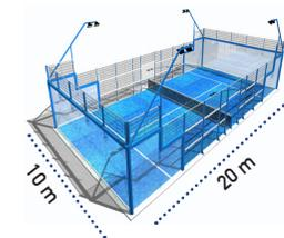
E' importante che il pavimento di un campo da padel rispetti i criteri di durezza, velocità e rugosità per garantire un ottimo scorrimento-rimbalzo della palla.
